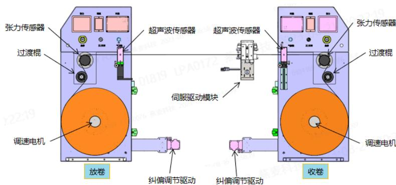
1) 通过张力传感器的反馈调节调速电机的速度以达到稳定的张力：卷料的卷径变化会影响料的张紧力，通过改变调速电机的实时速度来控制稳定的张力；
