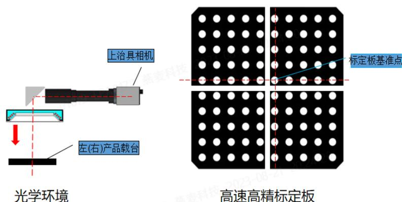
1) 通过光学标定板获得一套高精度等间距的密集圆点阵列，把相机视野中央跟选定的圆点中心对齐，然后参考圆点阵列的设计值，移动模组使圆点逐个在相机视野成像，计算每个圆点间实际运动值与圆点间距设计值的偏差，得到一套稀疏离散的补偿值矩阵。
