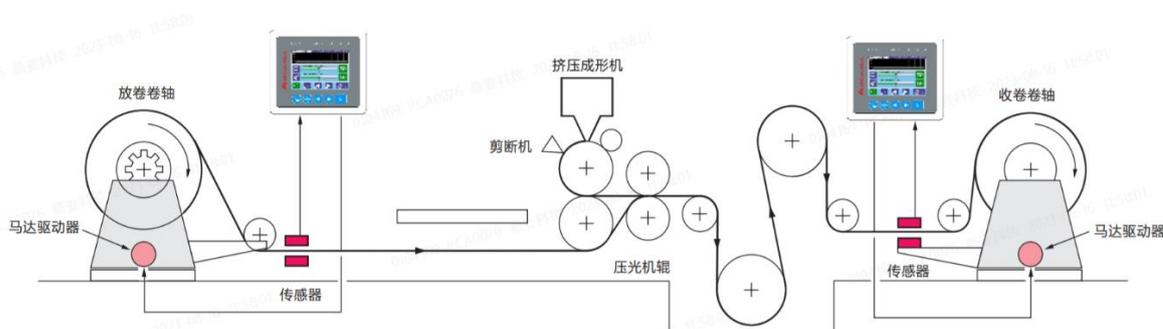
报告期内，在车载 FPC 测试行业中，由于车载 FPC 的尺寸较大，需要以放卷方式进行，同时对卷对卷拉料的速度、停止的位置、卷对卷拉料张力的控制等都有很严格的要求，需同时满足最优化才能保证效率。
